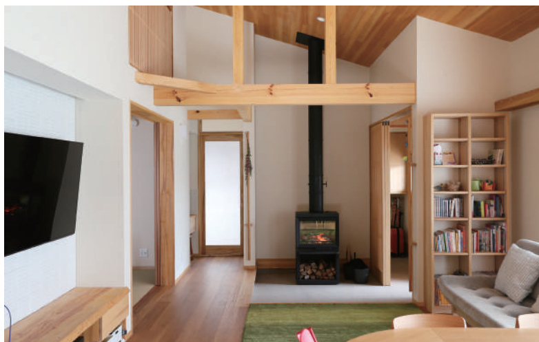
障子を開けると一階とつながるロフトをストーブの暖気が上昇し、階段を経由して一階へ戻る。 各部屋の出入り口はすべて引き戸。
